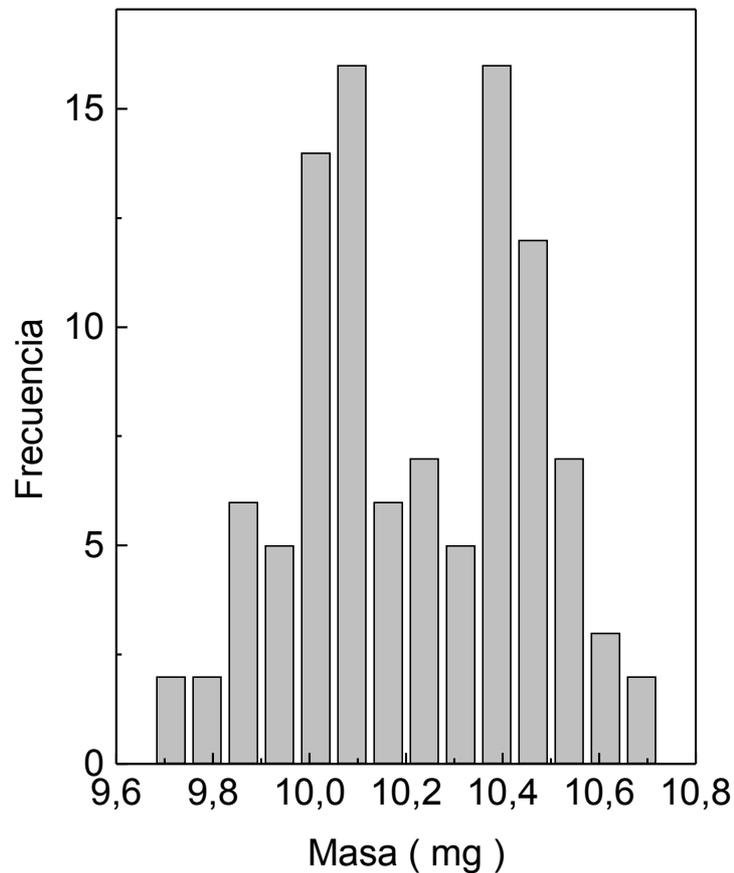
**Figura 1:** Histograma confeccionado con  $N = 104$  mediciones de la masa de una muestra
