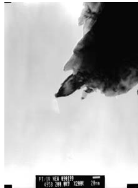
Figura 12: Punta de platino (Pt) cortada con alicate
