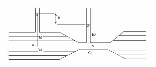
22. El tubo de Venturi representado en la figura, tiene una sección transversal de  $36~\text{cm}^2$  en las parte ancha y de  $9~\text{cm}^2$  en el estrechamiento. Cada 5s, salen del tubo 27~l de agua. a) Calcule las velocidades  $v_a$  y  $v_b$ , b) halle la diferencia de presiones entre las partes a y b, c) calcule la diferencia de alturas entre las columnas de mercurio del tubo en U.
