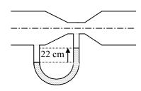
29 – Por un tubo horizontal como el de la figura circula un líquido. La diferencia de altura del líquido entre el tubo A y el acodado B (tubo de Pitot) es de 10 cm. Los diámetros de los dos tubos son iguales.
