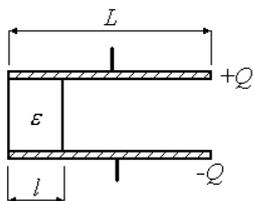
Entre las placas de un capacitor plano de sección  $A$  se coloca un dieléctrico como muestra la figura de arriba. Posteriormente se carga hasta que adquiere una carga  $Q$  y se lo desconecta de la fuente.
