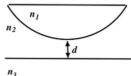
15. El dispositivo de anillos de Newton se modifica según muestra la figura. Datos:  $n_1 = 1.6$ ,  $n_2 = 1.5$ ,  $n_3 = 1.4$ ,  $\lambda = 500$  nm.
