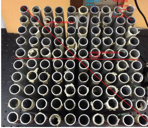
**Figura 3:** Dirección horizontal y diagonal en las que se realizaron las mediciones, indicando los parámetros del cristal.
