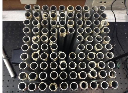
**Figura 4:** Defecto introducido en el cristal. Se retiraron los 4 tubos centrales a modo de analizar el cambio en el band-gap, y la existencia de resonancias dentro del mismo.
