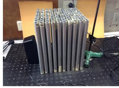
**Figura 2:** Diseño experimental utilizado. Se colocó el cristal entre el micrófono y el parlante, alimentado en primer lugar por un generador de funciones (al parlante) y adquirido por un osciloscopio (al micrófono), y luego reemplazándolos por un Lock-in conectado a ambos.
