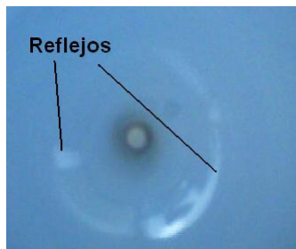
Figura 11: Fotografía del vórtice donde se observa con claridad los reflejos de luz que son medidos como picos de intensidad en el gráfico anterior.
