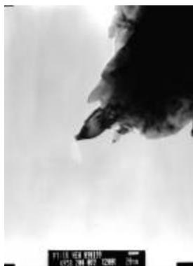
Figura 12: Punta de platino (Pt) cortada con alicate
