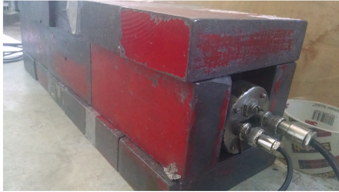
Figura 5: Vista trasera del PMT. Se observan los cables de alta tensión y la salida al amplificador. Además, se ve el blindaje de plomo donde se incluyó la muestra.
