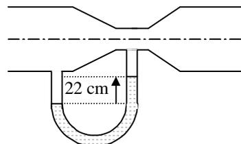
29) Por un tubo horizontal como el de la figura circula un líquido. La diferencia de altura del líquido entre el tubo A y el acodado B (tubo de Pitot) es de 10 cm. Los diámetros de los dos tubos son iguales.
