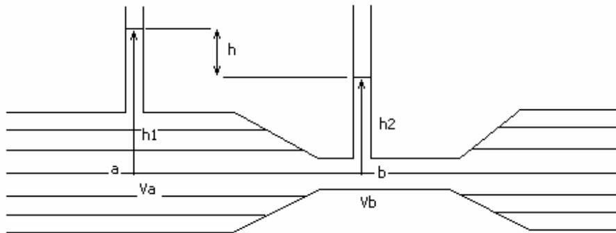
22) El tubo de Venturi representado en la figura, tiene una sección transversal de  $36\text{ cm}^2$  en las parte ancha y de  $9\text{ cm}^2$  en el estrechamiento. Cada 5s, salen del tubo 27 l de agua.
