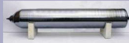
Se obtienen monocristales aplicando el método Czochralski por el cual se obtiene un cristal a partir de una semilla depositada en un baño de silicio fundido
