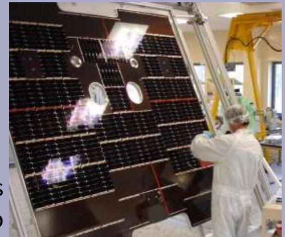
Trabajos de pegado de celdas sobre el sustrato
