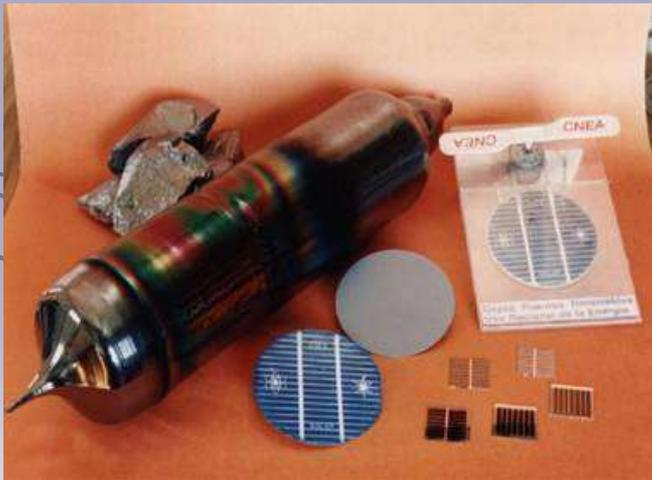
Algunos materiales involucrados en la fabricación de celdas solares de Silicio
