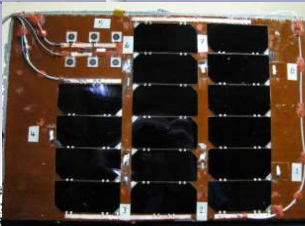
Ensayos de ciclado térmico rápido y termovació sobre paneles solares. (100°C y -100°C)
