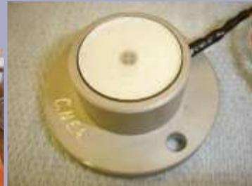
Radiómetro para la medición de la radiación solar
