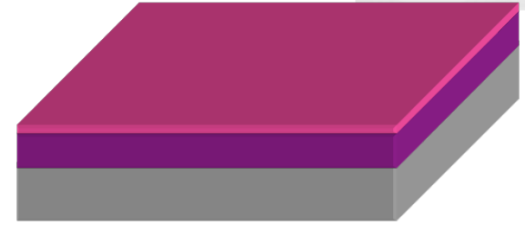
Película de material resist ( spin-coated )
