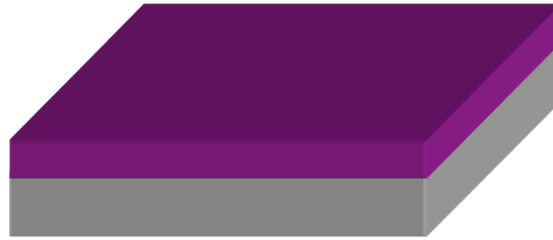
Deposito de Aluminio (de una solución o vapor)
