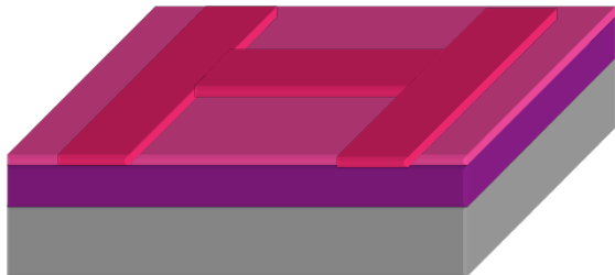
Exposición y transferencia del dibujo en la máscara al resist
