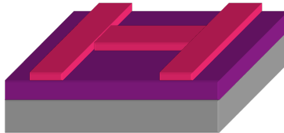
Revelado del fotoresist
