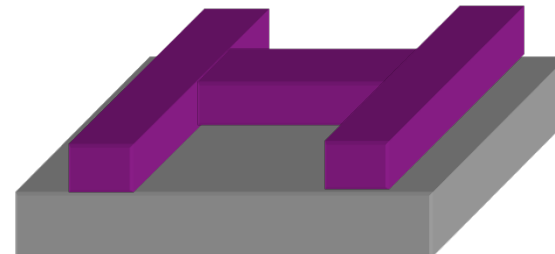
Removemos el fotoresist
