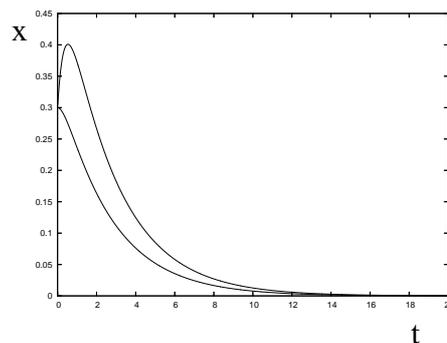
Un tiempo característico de la oscilación es  $\tau = \lambda^{-1}$ . Es el tiempo en que la amplitud cayó a un 36.8% de su valor inicial ( $e^{-1}=0.368$ ). Otro valor que caracteriza las oscilaciones amortiguadas es su coeficiente  $Q = \frac{\omega_0}{2\lambda}$ . Para sistemas oscilantes poco amortiguados Q toma valores altos (por ejemplo para un auto con amortiguadores en buen estado  $Q \sim 1$ , mientras que para una cuerda de guitarra es varios miles).
