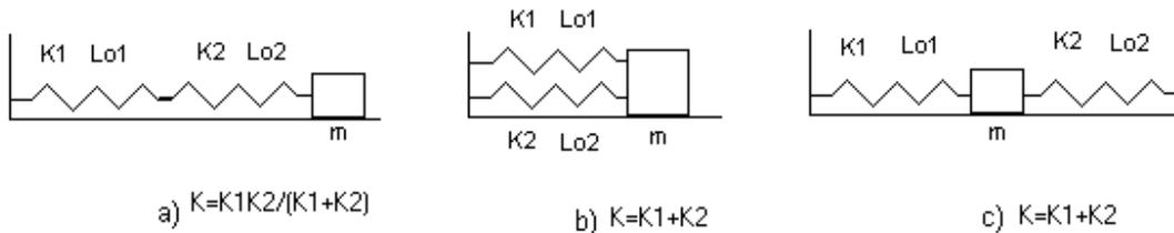
Se puede ver que para  $N$  resortes iguales de constante elástica  $K$ , su equivalente es  $K_{eq} = K/N$  si se colocan en serie, y  $K_{eq} = K \cdot N$  si se colocan en paralelo
