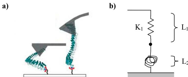
**Figura 1. a)** La caricatura muestra cuando la punta de prueba toca una molécula de proteína (izq) y la estira (der). La punta se deforma elásticamente por la fuerza realizada por la molécula al estirarse. **b)** En el modelo, el resorte representa a la punta de prueba y el ovillo a la biomolécula de interés. L1 y L2 son nulos cuando la punta de prueba o la proteína, respectivamente, tienen su longitud natural.
