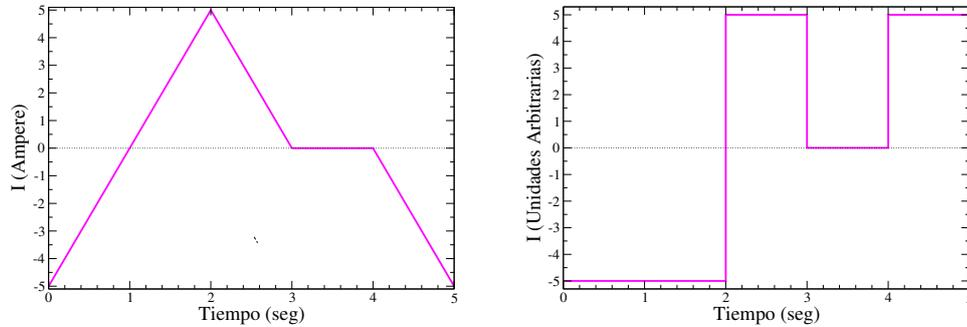
Figura 2: Izquierda: Intensidad de corriente en la espira externa en función del tiempo. Derecha: Intensidad de corriente inducida en la espira interna.
