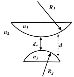
12. El diámetro del décimo anillo brillante por reflexión en un dispositivo de anillos de Newton varía desde 1.40 cm a 1.27 cm al introducir un líquido entre la lente y la placa. Cuál es el índice de refracción del líquido?
