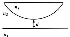
11. El dispositivo de anillos de Newton se modifica según muestra la figura. Datos:  $n_1 = 1.6$ ,  $n_2 = 1.5$ ,  $n_3 = 1.4$ ,  $\lambda = 500$  nm.
