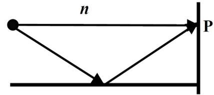
(b) Se deja el dispositivo en aire y se intercala en el camino del rayo que une la fuente con  $P$  (sin reflejarse en el espejo) una lámina de caras paralelas de índice de refracción 1.5. Determine el mínimo espesor de la placa para que en  $P$  se encuentre un máximo de interferencia.
