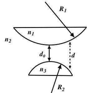
14. El diámetro del décimo anillo brillante por reflexión en un dispositivo de anillos de Newton varía desde 1.40 cm a 1.27 cm al introducir un líquido entre la lente y la placa. Cuál es el índice de refracción del líquido?
