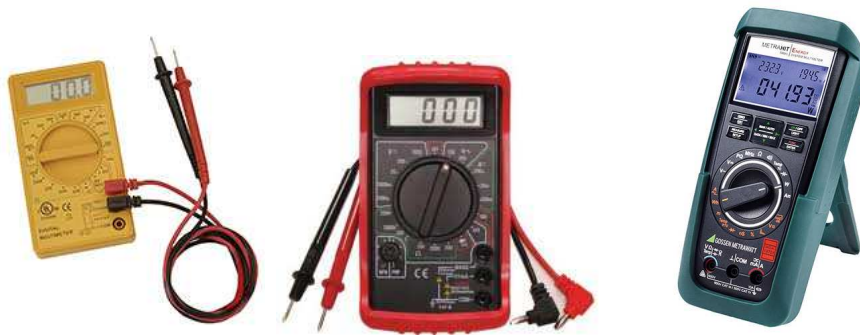
Figura 1.1: Ejemplos de multímetros digitales. Se destacan: la pantalla, llave selectora de función y escala, bornes de entrada, y puntas de prueba.
