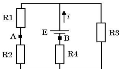
Rtas.  $i_1=i_2=i_3=2A$ ,  $R_4=1 \Omega$ ,  $\Delta V_{AB}=14V$
