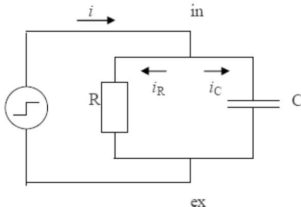
14. Se aplica el siguiente **escalón de corriente** a una célula de capacidad 50pF y resistencia de membrana  $500 \cdot 10^6 \Omega$  que se encontraba a  $V_0=0\text{mV}$ .
