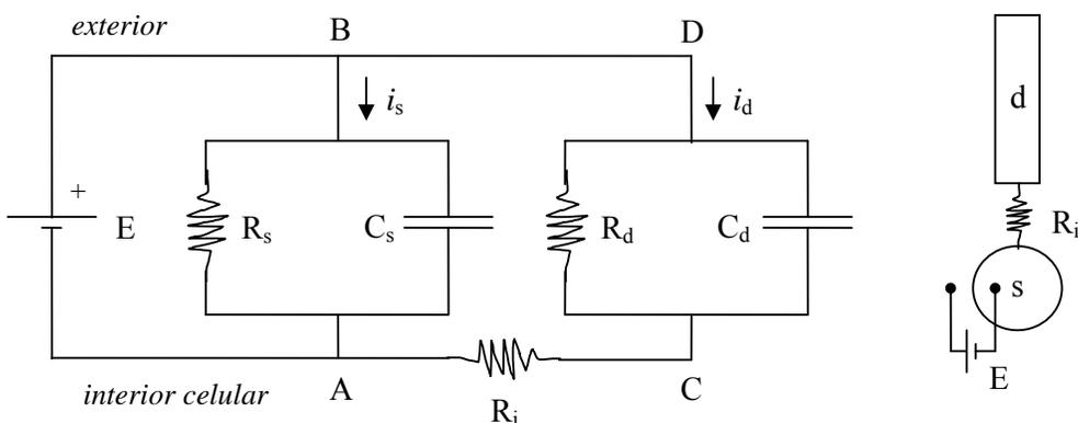
**Datos:**  $C_s = 5 \text{ nF}$  ;  $C_d = 1 \text{ nF}$  ;  $R_s = 1 \text{ G}\Omega$  ;  $R_d = 12 \text{ G}\Omega$  ;  $R_i = 1 \text{ G}\Omega$  ;  $E = 100 \text{ mV}$  (negativo en el interior). ( $\text{n}: 10^{-9}$  ;  $\text{G}: 10^6$  ;  $\text{m}: 10^{-3}$ )
