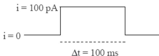
15. A una célula de capacidad 20pF y resistencia de membrana de  $100 \cdot 10^6 \Omega$  que se encontraba a un potencial  $V_0=0\text{mV}$ , se le aplican los siguientes escalones de corriente:
