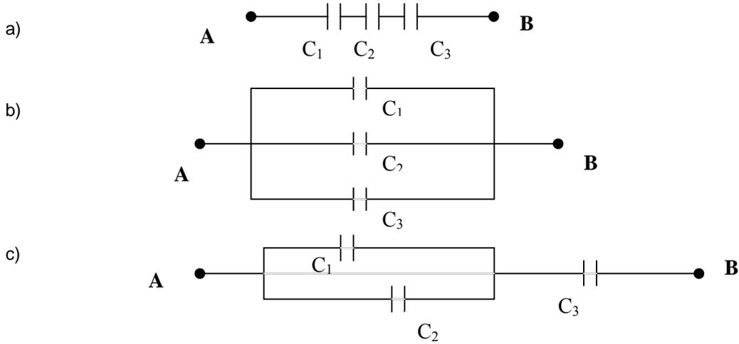
Resp: a)  $0,86 \mu\text{F}$  b)  $27 \mu\text{F}$  c)  $6,3 \mu\text{F}$ .
