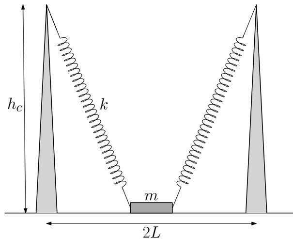
Figura 6: Esquema del *bungee invertido*.
