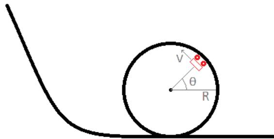
Figura 5: Esquema del rulo o *loop* de la montaña rusa.
