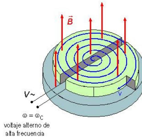
Figura 2: Esquema de funcionamiento de un ciclotrón, el precursor del sincrotrón. El campo magnético es uniforme y se aplica en la dirección perpendicular a la órbita de las partículas.
