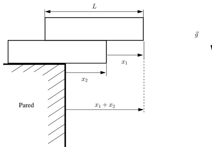
Figura 3: Dos ladrillos apilados.
