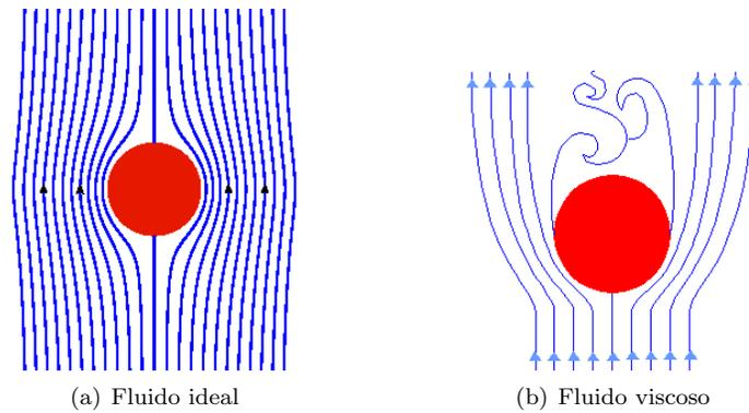
Figure 2: Cilindro en los dos tipos de fluidos
