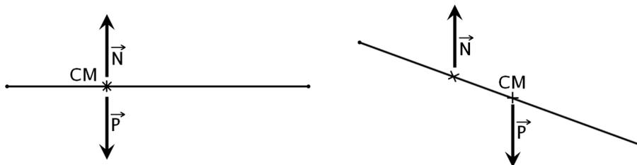
Figura 2: Desequilibrio que generado por distintos puntos de aplicación de la fuerza peso y la fuerza normal
