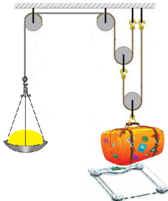
Figura 1: Esquema del arreglo empleado en la aduana de Lularia II para determinar el peso de los equipajes.
