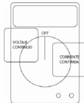
Figura 2: Multímetro, con la ubicación de los modos que utilizaremos remarcada. Dentro de cada modo están detalladas en el multímetro las escalas que deberán utilizar.
