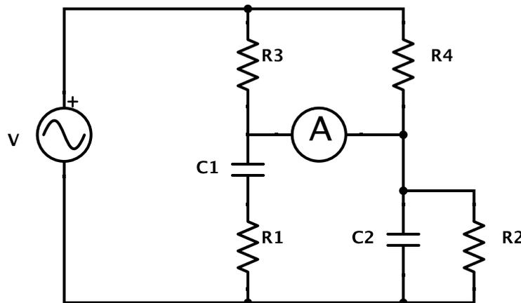
11. Deducir las condiciones de equilibrio para el puente que se muestra en la figura, donde  $Z_1 = R_1 + j X_1$  y  $Z_3 = R_3 + j X_3$ . Discutir la relación entre los signos posibles de  $X_1$  y  $X_3$  en el equilibrio. Resolver  $Z_3$  para el caso particular en que  $R_2 = 2 R_4 = 10\ \Omega$ ,  $R_1 = 1\ \Omega$  y  $X_1 = 0,5\ \Omega$ .
