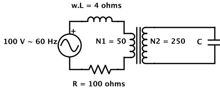
18. En el circuito de la figura, ¿qué valor (complejo) de la impedancia de carga  $Z_c$  corresponde a la máxima transferencia de potencia al secundario?
