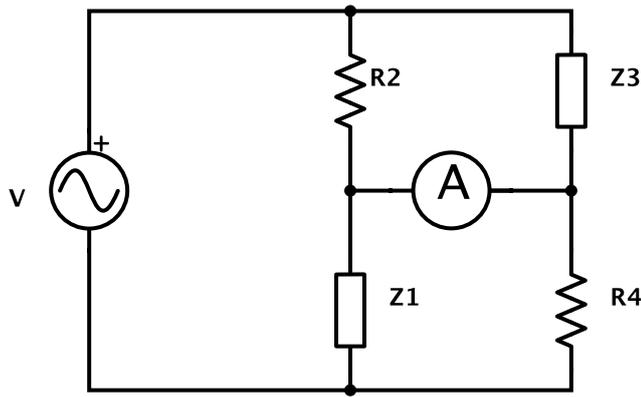
12. La figura muestra un desfaseador de voltaje.
