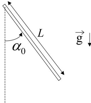
6 - Una varilla homogénea de masa  $M$  y longitud  $L$  es abandonada en reposo en la posición que se observa en la figura. Sus extremos deslizan sobre una superficie cilíndrica de radio  $R$ , sin rozamiento. La varilla se mueve en un plano vertical.
