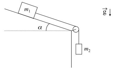
3 - El sistema de la figura, formado por dos partículas de masas  $m_1$  y  $m_2$ , parte del reposo y se mueve de tal forma que la masa  $m_1$  sube recorriendo todo el plano inclinado en un tiempo  $T$ . Intercambiando las partículas,  $m_2$  recorre todo el plano subiendo en un tiempo  $T/4$  (no hay rozamiento). Sabiendo que  $m_1/m_2 = 9$ , hallar  $\alpha$ .
