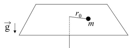
mueve en una trayectoria circular de radio  $r_0$  sobre una superficie horizontal sin fricción. El hilo pasa por un agujero en la superficie. Inicialmente su otro extremo se mantiene fijo. Si se tira lentamente del hilo, de forma que el radio disminuya, halle cómo varía la velocidad angular  $\omega$  en función de  $r$ , sabiendo que para  $r = r_0$  la velocidad angular era  $\omega_0$ .
