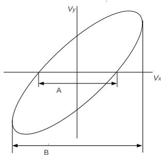
Figura A.2: Figura de Lissajous para el caso de frecuencias iguales.
