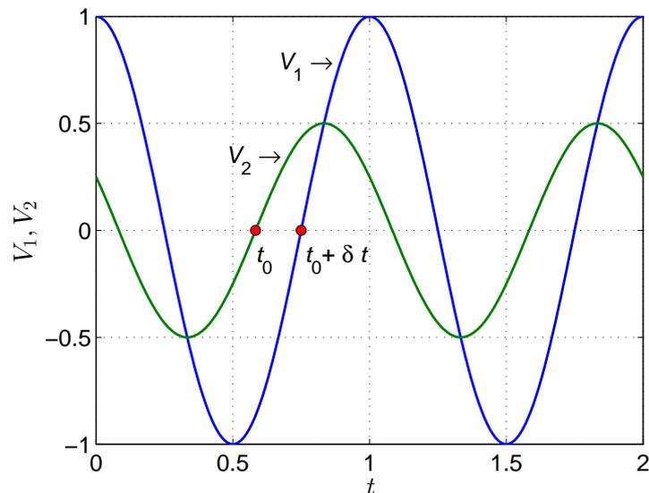
Figura A.1: *Ejemplo de dos señales armónicas defasadas, de igual frecuencia y diferente amplitud.*
