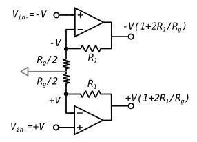
EXTRA 1: Noten que esta configuración tiene una ganancia diferencial que se puede variar cambiando una única resistencia, tiene una impedancia de entrada muy alta, y un CMRR muy alto.
