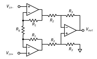
AYUDA: Utilicen las tensiones de entrada en la base diferencial y de modo común. Cuando  $V_{diff}=0$  no fluye corriente por la resistencia  $R_g$ . Por esta razón los dos primeros operacionales funcionan cada uno como un seguidor, con ganancia 1. Cuando  $V_{CM}=0$  se pueden pensar como dos amplificadores no inversores con una tierra virtual en la mitad de la resistencia  $R_g$ . De este modo, cada amplificador tiene una ganancia  $1+2R_1/R_g$ .
