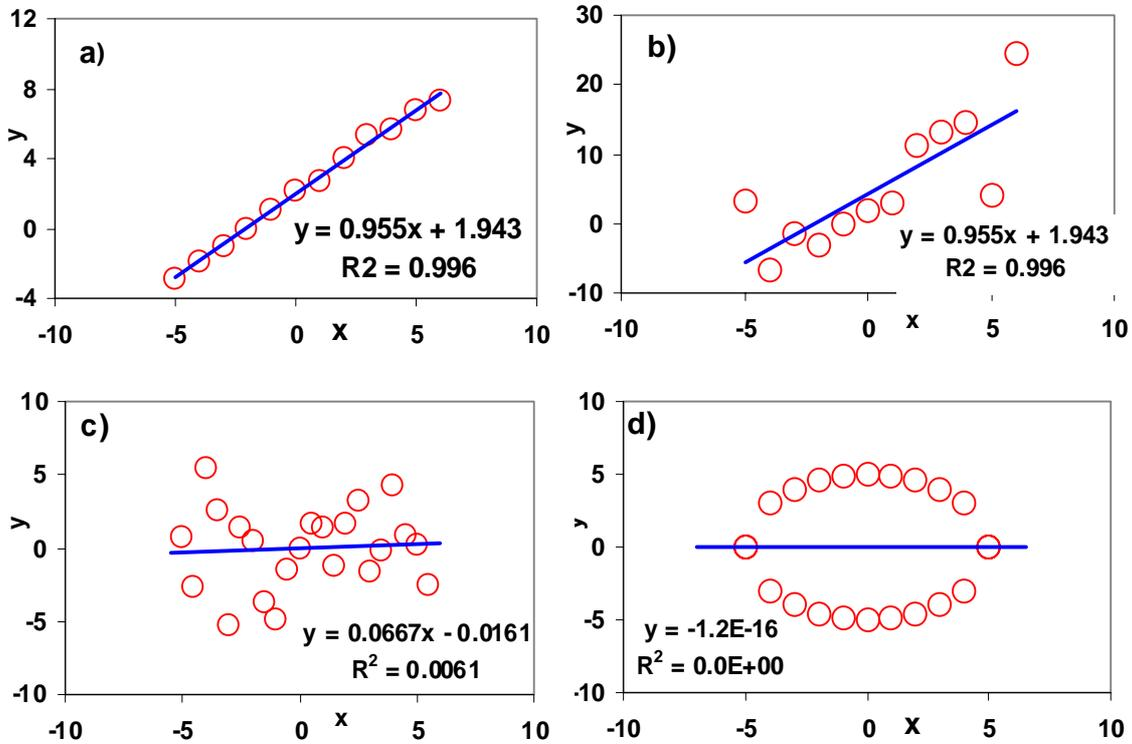
**Figura 2** Ajuste de datos experimentales por un modelo lineal. a) Caso de una buena correlación lineal, b) aceptable, c) ex un caso en el prácticamente no ha correlación entre X e Y. , d) tiene un buen correlación pero el modelo lineal es inadecuado.
