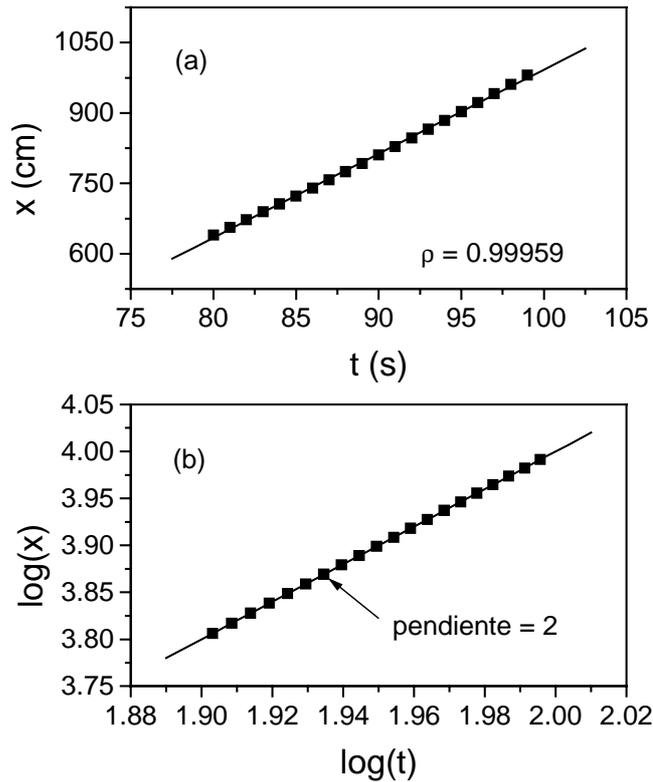
**Figura 3** Representación de  $x(t)$  para un cuerpo que se mueve con movimiento uniformemente acelerado. (a) A tiempos largos no se aprecia bien la curvatura de la curva y, dado que el coeficiente de correlación lineal es muy cercano a la unidad, podría suponerse que la correlación es lineal. (b)  $\log(x)$  en función de  $\log(t)$ , de donde se deduce que la relación no es lineal sino cuadrática.
