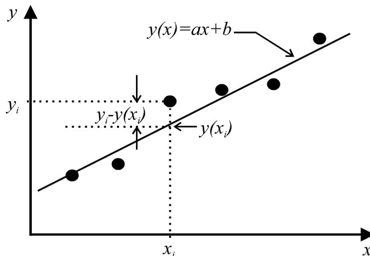
**Figura 1** Gráfico de datos asociados a un modelo lineal. La cantidad  $y_i - y(x_i)$  representa la desviación de cada observación de  $y_i$  respecto del valor predicho por el modelo  $y(x)$ .
