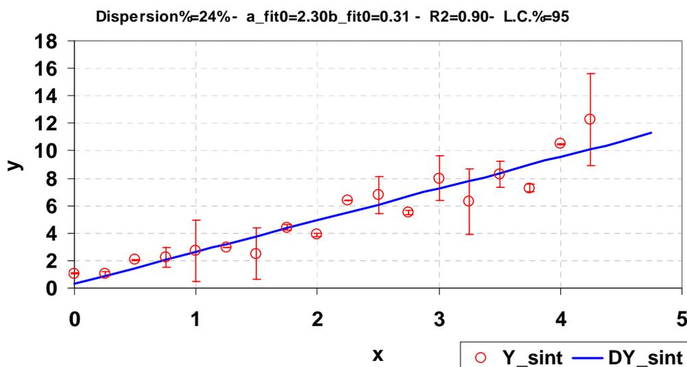
**Figura 1.-** Representación gráfica de un conjunto de datos experimentales  $(X_i, Y_i)$  con errores en el eje Y dado por los valores  $\sigma_i$ . La línea continua azul es la recta obtenida por cuadrados mínimos.
