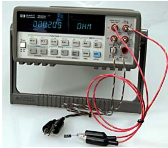
Método e medición a cuatro puntas
