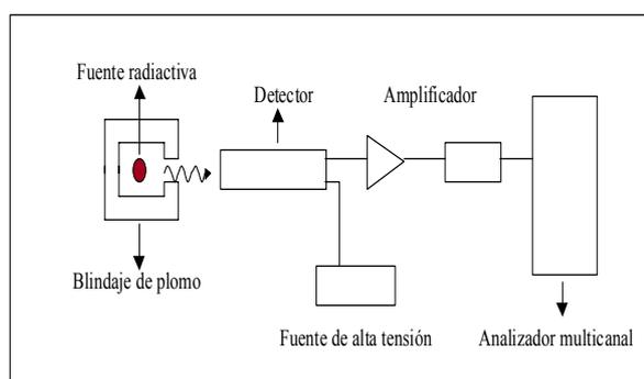
Figura 1: Esquema del dispositivo experimental.
