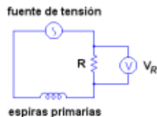
Figura 2 – Esquema del circuito primario para las mediciones sin blindaje.
