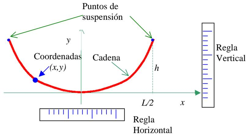
**Figura 2.** Cadena o cuerda flexible suspendida por sus extremos de dos puntos fijos, las reglas graduadas, permiten definir una escala absoluta para medir las distancias. Es aconsejable colocar la cámara sobre un eje perpendicular al plano de la catenaria y que pase cerca del origen de coordenadas. Asegúrese de que las reglas estén bien verticales y horizontales respectivamente.
