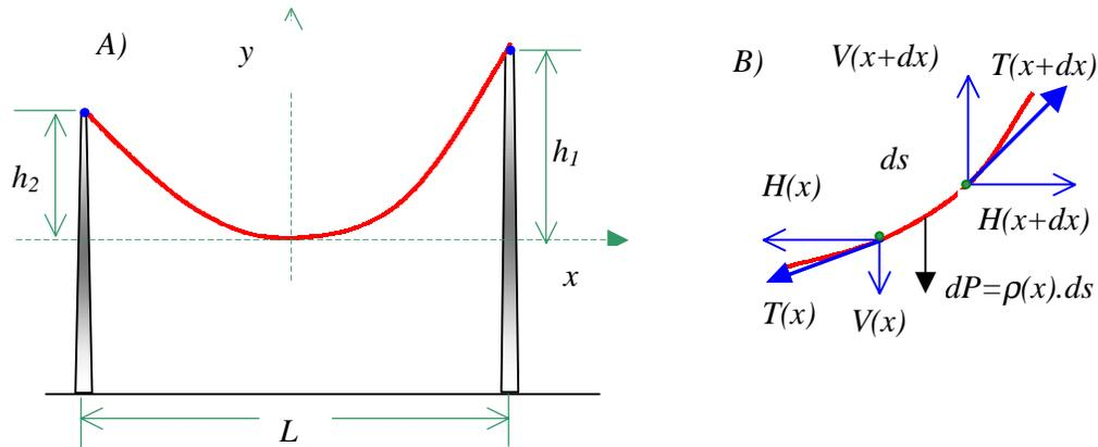
**Figura 1.** A) Cadena o cuerda flexible suspendida por sus extremos de dos puntos fijos. Las coordenadas de dichos puntos son  $(-L_2, h_2)$  y  $(L_1, h_1)$ , con  $L_1 + L_2 = L$ . B) Fuerzas que actúan sobre un segmento infinitesimal de cuerda de longitud  $ds$ .
