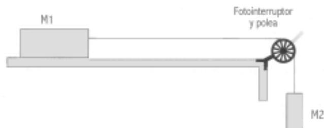
Fig1: Dispositivo experimental para estudiar fuerzas de rozamiento dinámico
