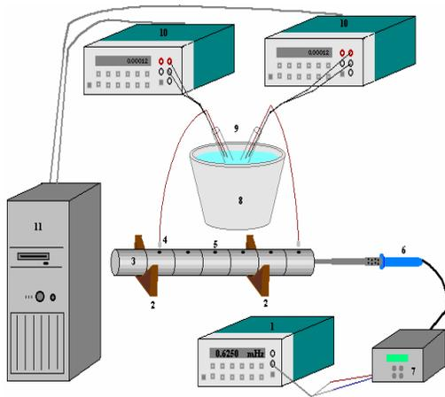
**Figura 3:** Montaje del experimento. 1) generador de funciones; 2) tabiques de madera para sostener la barra; 3) cilindro de cobre aislado 4) termocuplas; 5) orificios en el cilindro de cobre ; 6) soldador introducido en el extremo del cilindro; 7) contactor conectado al generador de funciones; 8) recipiente de telgopor con agua y hielo; 9) puntas frías de las termocuplas introducidas en el recipiente; 10) multímetros; 11) computadora a la que se conectan los multímetros.
