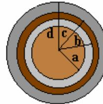
**Figura 2:** Corte transversal de la barra. El interior corresponde al cilindro de cobre. La primera capa es de acrílico, la segunda es un tubo de PVC y la capa exterior consta de dos vueltas de espuma aislante.
