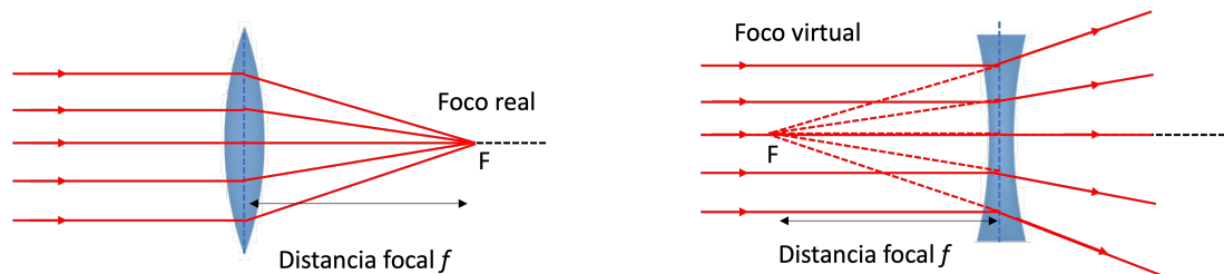
Figura 9.2: El foco de las lentes convergentes (a) y divergentes (b)
