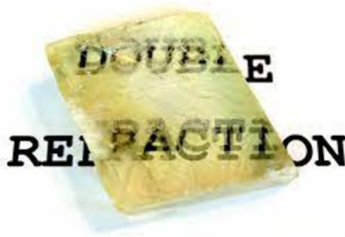
Figura 7.14: Dobles refracciones en la calcita
