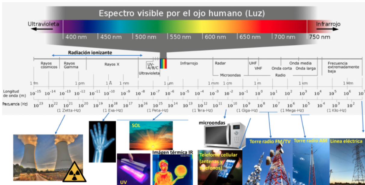
Figura 7.1: Esquema de los tipos de ondas y frecuencias que abarca el espectro electromagnético, donde solo una pequeña porción es visible para el ojo humano. Se muestran ejemplos de fuentes que generan esas ondas
